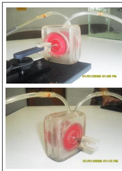
Figura 5. Modelo del funcionamiento del corazón como herramienta didáctica para el aprendizaje de movimiento mecánico y circuitos eléctricos (RC).
