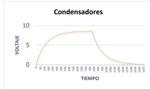
Figura 4. Carga y descarga del condensador
